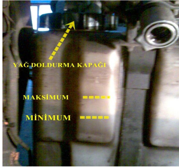
Resim 7.3: Damper haznesi yağ kontrolü
