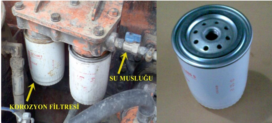
Resim 7.4: Korozyon filtresinin araç üzerindeki yeri ve yeni korozyon filtresi
