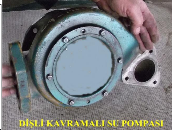
Resim 9.1: Kayış kasnaklı ve dişli kavramalı su pompası
